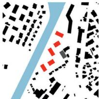
Die Variante sieht fünf Baukörper vor, welche sich parallel zur bestehenden Überbauung der IBI und der Arbeiterhausreihe positionieren (historischer Strassenraster) und schräg zum Kanal stehen. In der präsentierten Variante sind Längs- und Querfassaden zueinander versetzt.
