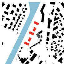
Die Variante sieht fünf Baukörper vor, welche orthogonal zum Kanal und schräg zu den bestehenden Gebäuden (historischer Strassenraster) gesetzt sind.
