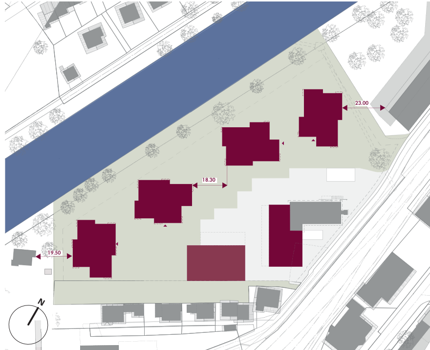
Abb. 27 Setzung der Gebäude
