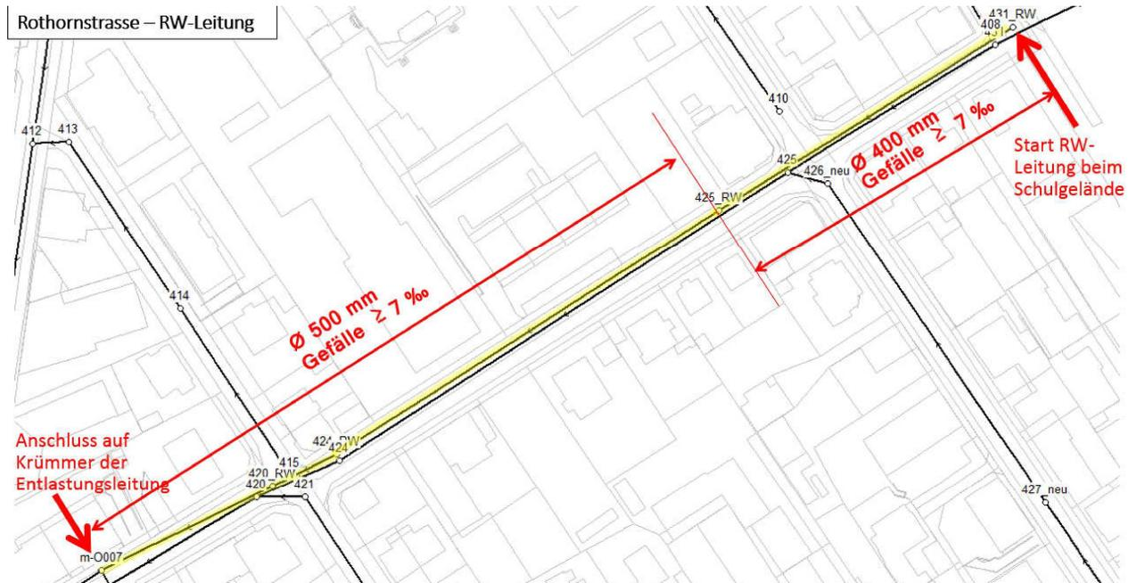
Abbildung 9: Situation und Dimensionen der neuen Regenwasserleitung in der Rothornstrasse gemäss Variante 2
