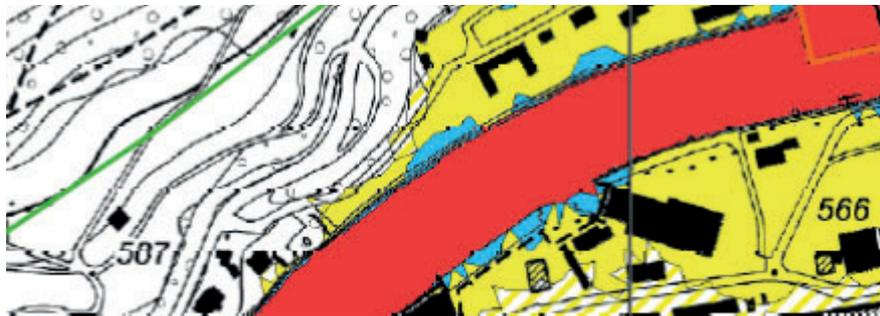
Abb. 40 Auszug aus der überarbeiteten Gefahrenkarte: Teile der Freifläche Sackgut (USZF 3) werden vom Gefahrengebiet mit mittlerer zu geringer Gefährdung rückgestuft.
