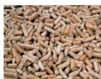
Zur Herstellung der 5 bis 45 Millimeter langen, zylinderförmigen Pellets werden Sägemehl und Hobelspäne aus der Holzverarbeitenden Industrie unter hohem Druck durch ein Sieb gepresst.
